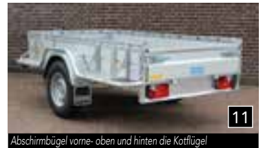
Abschirmbügel vorne- oben und hinten die Kotflügel
