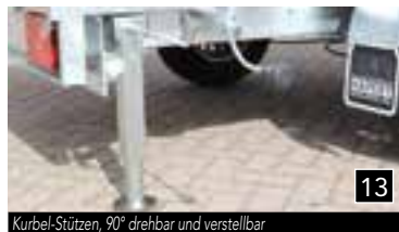
Kurbel-Stützen, 90° drehbar und verstellbar
