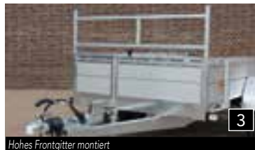
Hohes Frontgitter montiert
