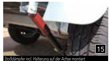
Stoßdämpfer incl. Halterung auf der Achse montiert
