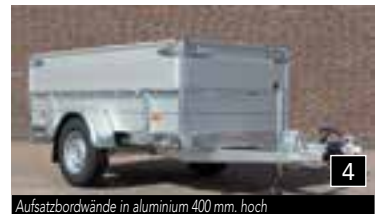
Aufsatzbordwände in aluminium 400 mm. hoch
