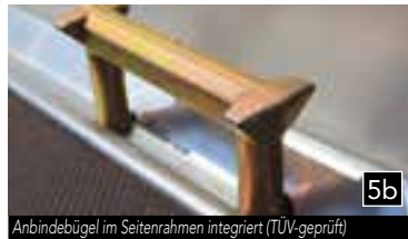
Anbindebügel im Seitenrahmen integriert (TUV-geprüft)
