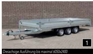
Dreilachsige Ausführung bis maximal 6050x2400
