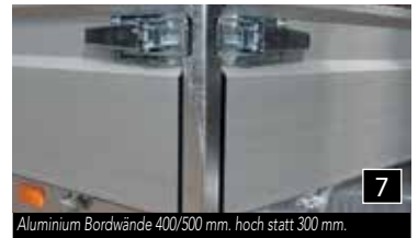
Aluminium Bordwände 400/500 mm. hoch statt 300 mm.
