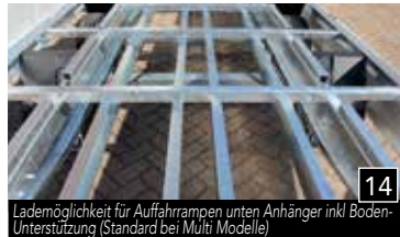
Lademöglichkeit für Auffahrampen unten Anhänger inkl Boden-Unterstützung (Standard bei Multi Modelle)
