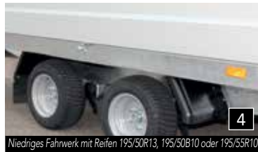
Niedriges Fahrwerk mit Reifen 195/50R13, 195/50B10 oder 195/55R10
