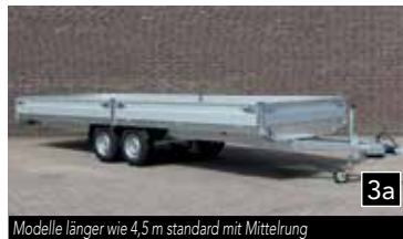
Modelle länger wie 4,5 m standard mit Mittelrung
