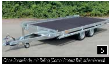
Ohne Bordwände, mit Reling (Combi Protect Rail, scharnierend)
