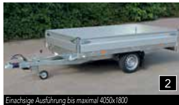
Einachsige Ausführung bis maximal 4050x1800
