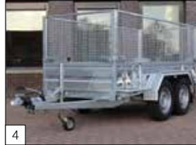
Optie: gegalvaniseerde stalen borden, robuuste ALU-spatborden, afneembaar gaasrekwerk en afschermbegels uit één stuk gemonteerd.
