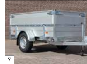
Optie: afneembare aluminium opzetborden ca. 40 cm hoog voorzien van degelijke sluitingen.
