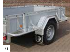
Optie: afschermbegels voor, boven en achter de spatborden (uit één stuk), voorzien van aluminium opstap. Spatborden van aluminium tranenplaat.
