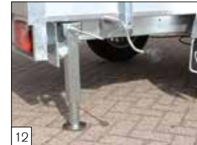
Optie: verstelbare en draaibare uitzetsteunen en voorzien van afneembare slinger.
