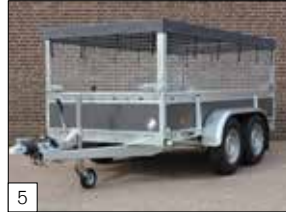
Optie: gaasrekwerk 75 cm hoog (afneembaar) en een fijnmazig ladingnet (gemonteerd).
