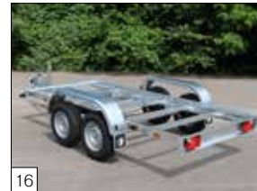
Optie: model L-2 'Chassis', als extra optie is o.a. een multiplex vloerplaat mogelijk.
