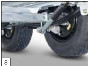
Optie: paraboolvering inclusief schokbrekers.
