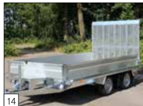
Optie: aluminium voor- en zijborden 30 cm hoog.
