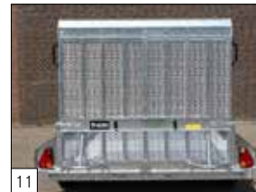
Standaard: doorlopende achterklep van 1500 mm hoog incl. steunen en degelijke vering.
