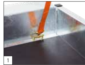
Standaard: bindbeugels met een capaciteit van 1000 daN geïntegreerd in de vloer.
