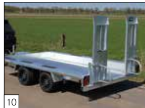
Optie: paraboolvering incl. banden met zwarte velgen 195/50 R13 of 185/70 R 13 C en aluminium profiel vloer gemonteerd.
